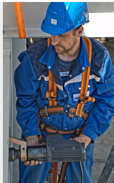
Гайковерты серии alkitronic ® EFCip оснащены панелью управления с графическим OLED-дисплеем и интуитивно понятным интерфейсом. Фото справа: использование при возведении стальных конструкций
